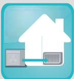
Le module hydraulique intégré dans l'unité extérieure est directement relié au circuit de chauffage, sans liaison frigorifique à réaliser.
